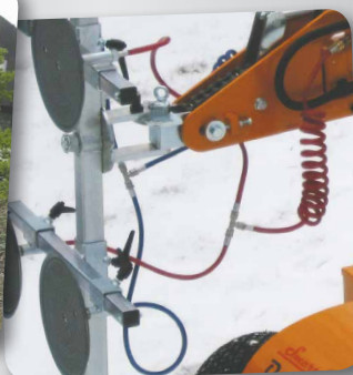
Liftens vakuum er separeret ud i to kredse for højeste sikkerhed. Her ses vakuumkredse med henholdsvis blå og røde vakuumslanger.
